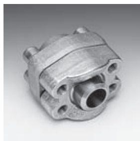
ACCOPPIAMENTO SEMIFLANGIA INTERA FORI FILETTATI CON CODOLO A SALDARE DI TESTA E FLANGIA FILETTATA GAS
